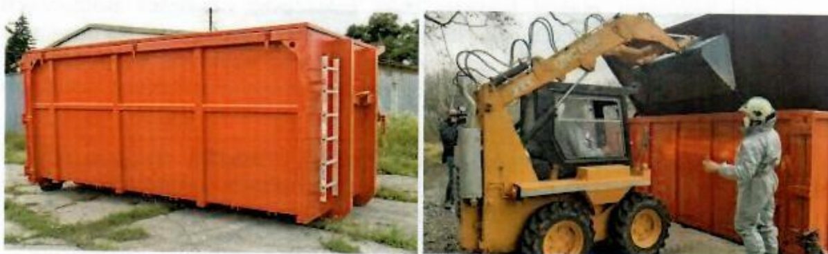
Manipulátor a kontajner určené na uskladnenie PCB látok po špeciálnych úpravách nasadené v teréne
